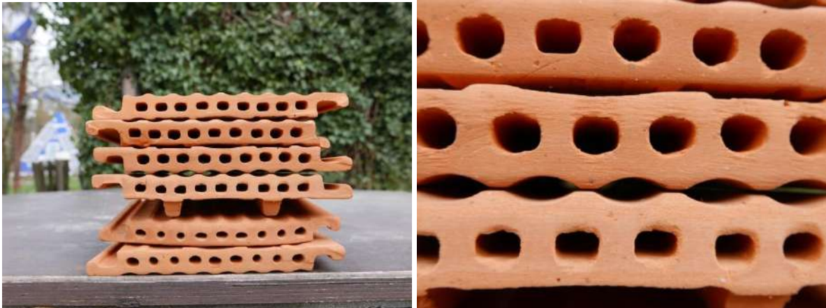
Abbildung: Halbierte Strangfalzziegel (links) und Detailaufnahme der geschliffenen Öffnungen (rechts)
