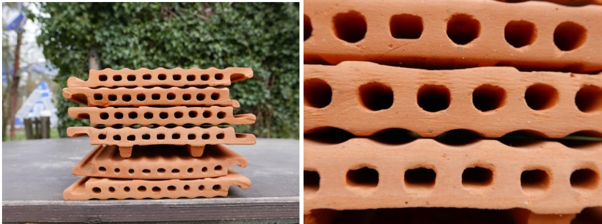
Abbildung: Halbierte Strangfalzziegel (links) und Detail der geschliffenen Öffnungen (rechts)
